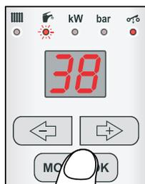
Prin apăsarea butonului MODE/OK se va trece de la afișarea temperaturii AC la modul de setare a temperaturii AC din sistem. Acest mod este indicat de iluminarea intermitentă a LED-ului
