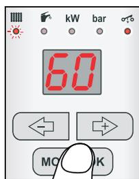
Prin apăsarea butonului MODE/OK se va trece de la afișarea temperaturii la modul de setare a temperaturii din sistem. Acest mod este indicat de iluminarea intermitentă a LED-ului
