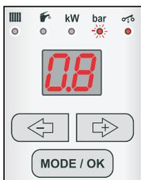
Atunci când presiunea apei de încălzire din sistem scade sub 0,8 bari, LED-ul pentru bari începe să lumineze intermitent. Centrala va continua să se încălzească, dar va
