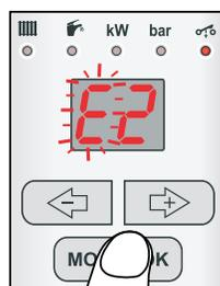
Prin apăsarea butonului MODE/OK se va trece de la afișarea curbei echitermice din sistem la modul de setare a curbei echitermice. Acest mod este indicat prin afișarea intermitentă
