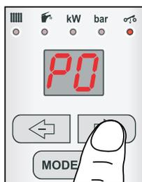
Afișarea pantei curbei echitermice selectate nu este indicată de niciun LED de pe panoul de comandă. Prin apăsarea butonului (+) veți trece la afișarea următorului parametru.
