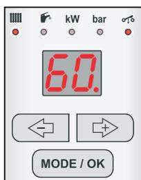
Afișarea temperaturii curente din sistem este indicată prin aprinderea LED-ului de pe panoul de comandă. Dacă se aprinde LED-ul din colțul dreapta jos, înseamnă că centrala a trimis o
