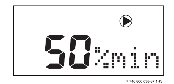
Fig. 49 Mesaje de display „Modulația pompelor“
